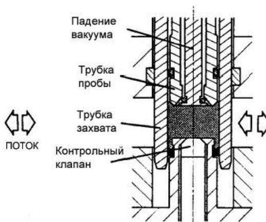
“Захват” пробы изолирован, поток продолжает проходить через пробоотборник
